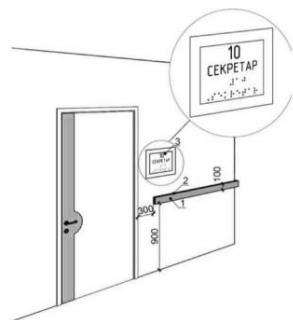
Малюнок 23 – Приклад розміщення тактильних інформаційних покажчиків приміщень: 1 - інформаційна направляюча; 2 - тактильна інформаційна позначка; 3 - інформаційна тактильна табличка (шрифтом Брайля)
