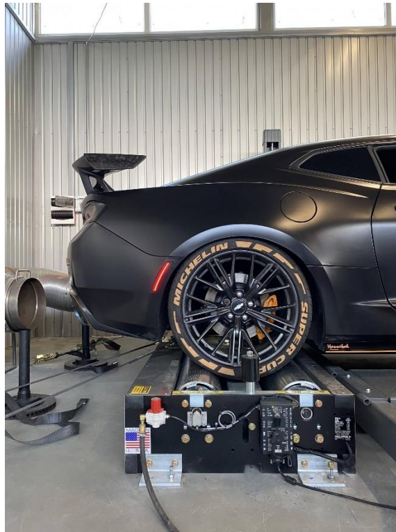
Рис. 4.12 Типова конструкція динамометричного стенду
