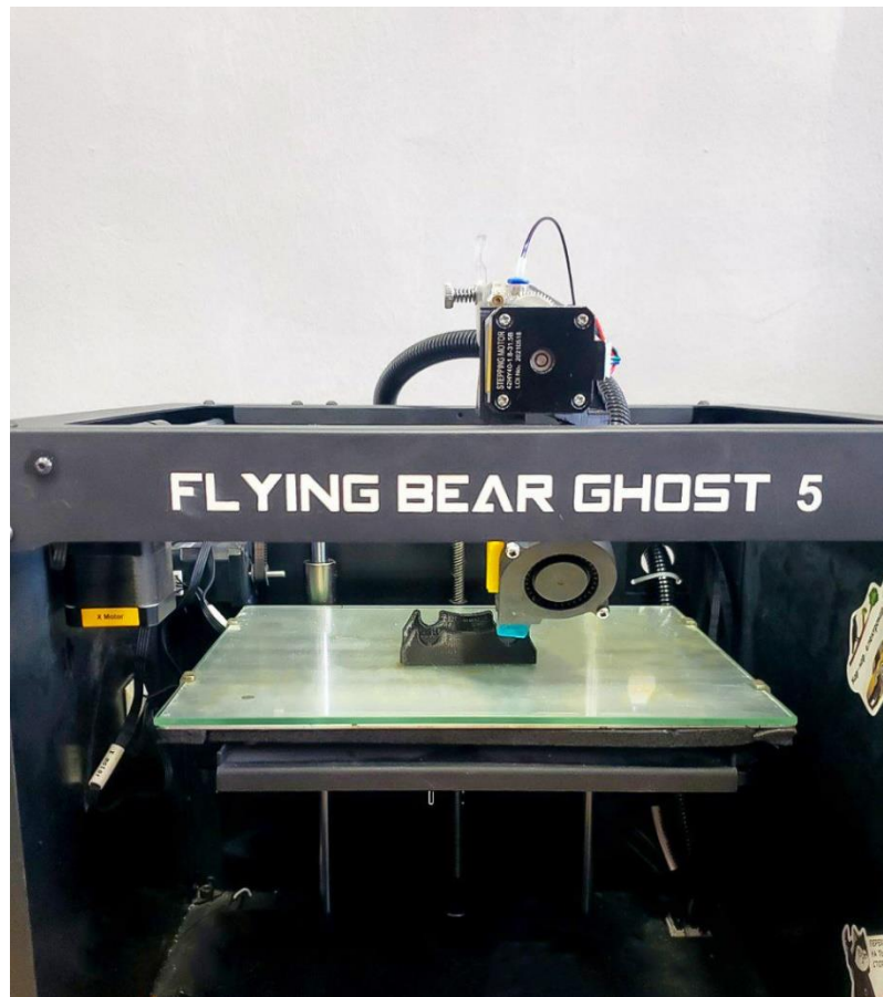
Рис. 5.12 Процес друку пластикових опор з роликами
