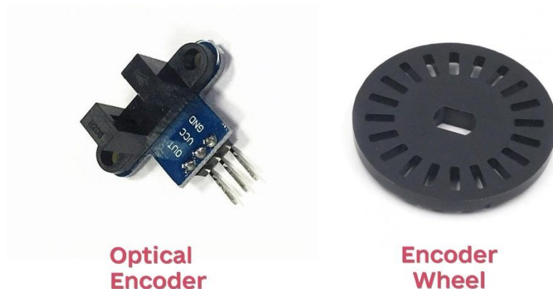
Рис. 4.9 Оптичний енкодер та колесо з отворами [15] [16]
