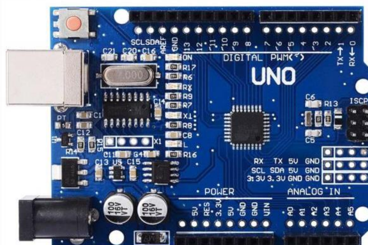
Рис. 4.1 Зовнішній вигляд Arduino Uno
