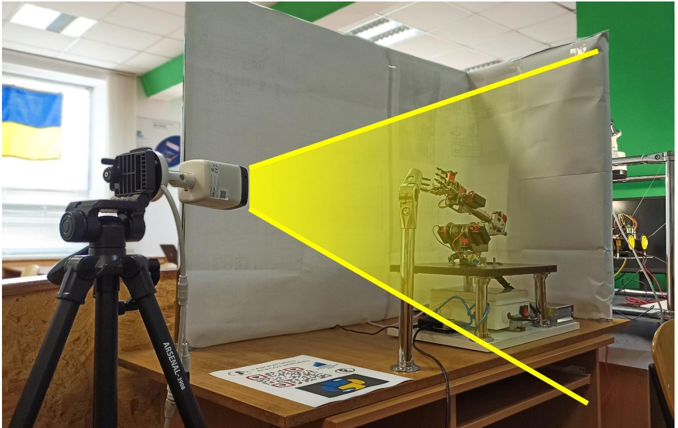
Рис. 5.8 Налаштування IP камери. Визначення дистанції та куту розміщення за допомогою штатива.
