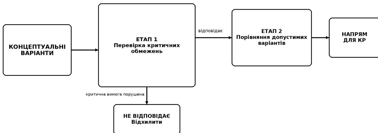
Рисунок 1.3 – Двоетапний принцип відбору концептуальних рішень
