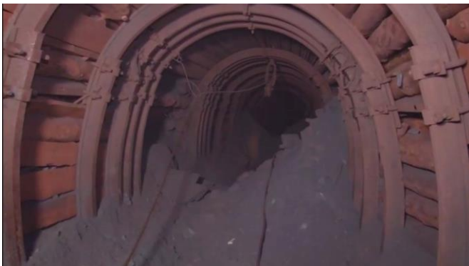
Рисунок 5.1 – Фотофіксація у штреку скреперування (а) та дучці (б) результатів подрібнення руди після відбивання масиву за допомогою наливної ЕВР Україніт-ПП-2 при відпрацюванні запасів експериментального блоку
