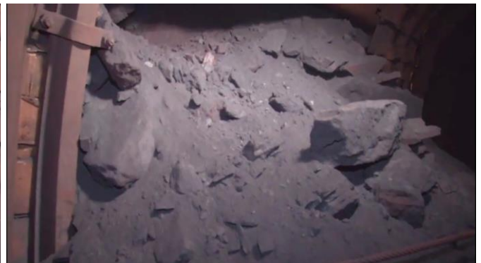
Рисунок 5.1 – Фотофіксація у штреку скреперування (а) та дучці (б) результатів подрібнення руди після відбивання масиву за допомогою наливної ЕВР Україніт-ПП-2 при відпрацюванні запасів експериментального блоку
