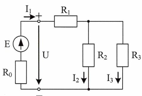
Джерело напруги з електрорушійною силою  $E = 120$  В і внутрішнім опором  $R_0 = 2$  Ом ввімкнено в ланцюг, де опори резисторів дорівнюють:  $R_1 = 18$  Ом,  $R_2 = 100$  Ом,  $R_3 = 150$  Ом. Струм  $I_1 = 1,5$  А. Визначити загальний опір паралельних гілок  $R_{23}$ .
