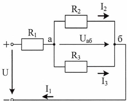
На рисунку наведено схему електричного кола з опорами, значення яких  $R_1 = 18 \text{ Ом}$ ;  $R_2 = 30 \text{ Ом}$ ;  $R_3 = 20 \text{ Ом}$ ; напруги  $U = 120 \text{ В}$ ,  $U_{ab} = 48 \text{ В}$ . Визначити еквівалентний опір ділянки  $ab$   $R_{ab}$ .
